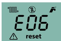
Например, когда на экране устройства отображаются коды неисправности E81 или E06, это означает, что в вашем устройстве не произошло возгорания. В этом случае любой из клапанов газовой линии, подключенных к комби, может быть закрыт, комби будет перезапущен после открытия закрытого клапана и нажатия кнопки СБРОС. Если комби не запускается с перезагрузкой, обратитесь в нашу авторизованную службу.
