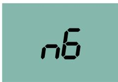
Когда комби запустится в первый раз, на экране отобразится буква n6, а затем число (например, 24), указывающее мощность устройства в кВт.
