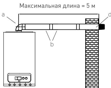
Рисунок 15 Монтаж дымохода с одним угловым отводом 90°.
