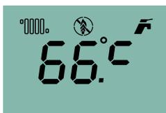
Вы можете увеличивать (14) и уменьшать (15) температуру с помощью кнопок регулировки температуры в диапазоне от 25 до 80
